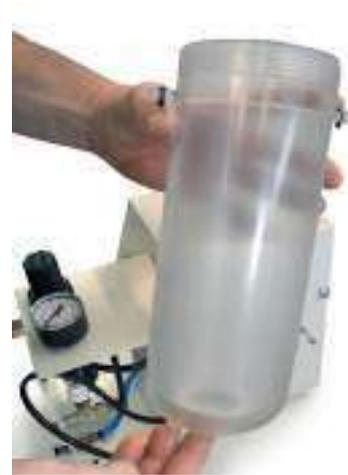
**(4)** Scollegare i due tubi rilsan di alimentazione pneumatica del distributore dai raccordi rapidi ad esso montati
