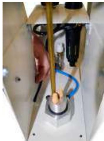
**(5)** Rovesciare la sabbiatrice e svitare le due viti a testa bombata ed incasso a croce che fissano il distributore dell' aria al telaio della sabbiatrice.
