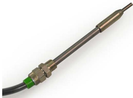
**(2)** Svitare dalla lancia l'ugello prestando attenzione a ripulire dai filetti il teflon precedentemente messo per garantire tenuta pneumatica
