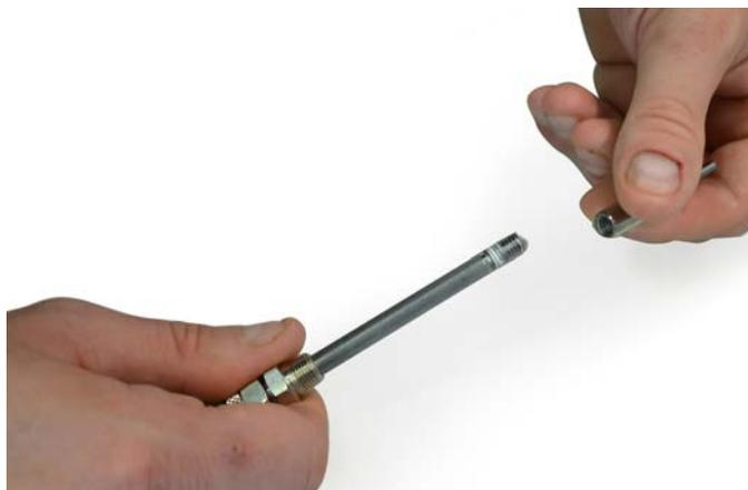
Prima di affettuare la procedura di montaggio dell'ugello, risulta necessario pulire le parti smontate con una pistola di soffiaggio e utilizzare un giro di nastro di teflon così da garantire la tenuta pneumatica tra le due parti metalliche avvitate tra loro.
