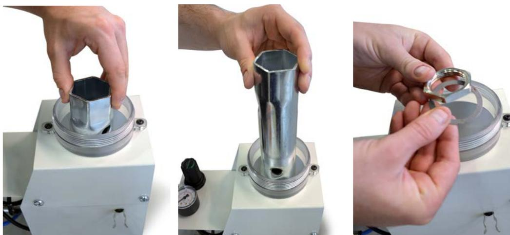
**(3)** Smontare il serbatoio della graniglia dal telaio svitando le due viti a testa bombata ed esagono incassato presenti sulla parte superiore della sabbiatrice
