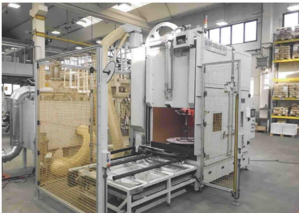
L'impianto progettato e costruito da **Norblast** per la pallinatura controllata di trasmissioni di potenza con applicazione in ambito siderurgico.
