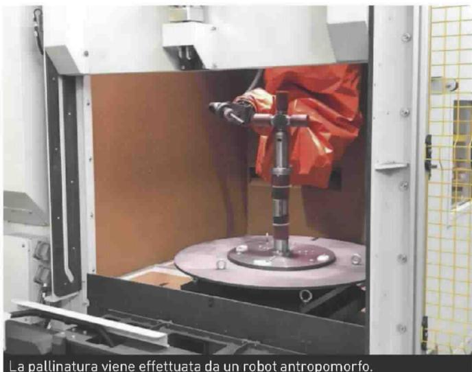
La pallinatura viene effettuata da un robot antropomorfo.
