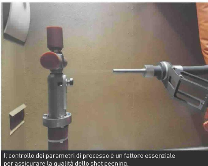
Il controllo dei parametri di processo è un fattore essenziale per assicurare la qualità dello shot peening.
