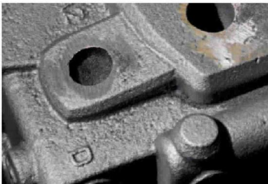
Al termine del processo di produzione, le fusioni, devono essere ripulite da tutti i residui di lavorazione.
