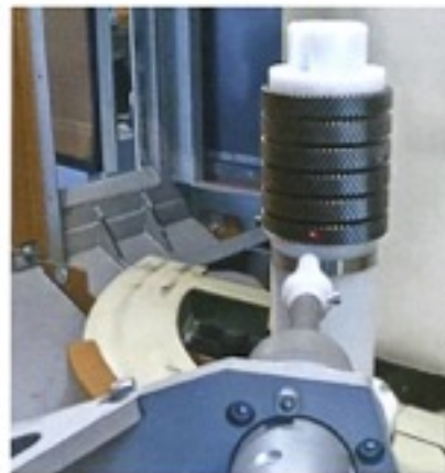
Dettaglio puntamento laser su impianto automatico di shot peening Norblast.
